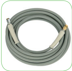
Hogedrukverlengslang met snelkoppelingen van 10 m tot 25 m en voor werkdrukken van \leq 250 bar, \leq 350 bar en \leq 500 bar code : 1.208.520.xxx ( \leq 250 bar) 1.208.540.xxx ( \leq 350 bar) 1.208.560.xxx ( \leq 500 bar)
